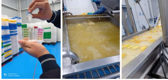
Fig. 1. Medición de pH del agua en línea de lavado
