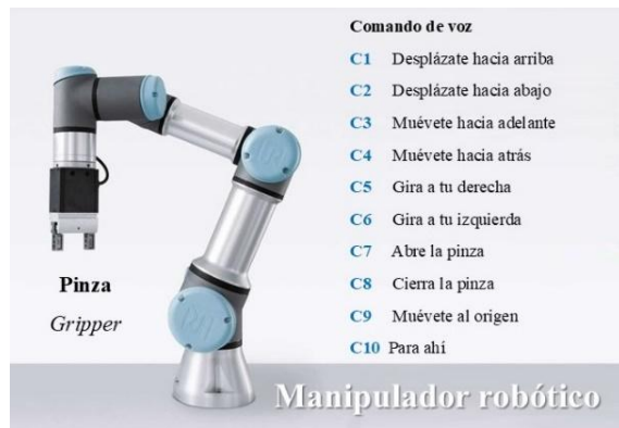
Fig. 4. Descripción de los comandos de voz de C1 a C10 propuestos para el control de un manipulador robótico colaborativo UR3 [11].
