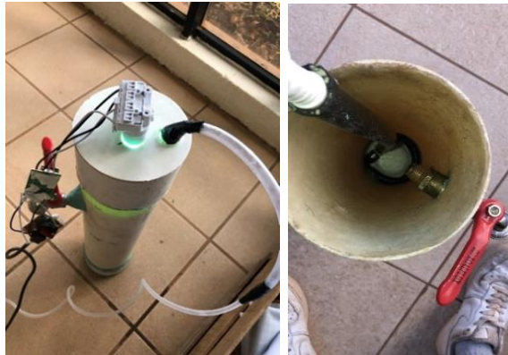
Fig. 4. Sistema de iluminación adherido al reactor.
